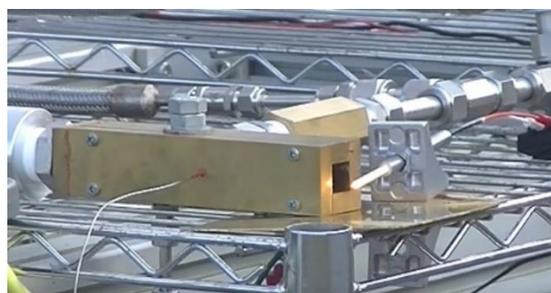
図 6 水素-空気予混合気の着火写真
