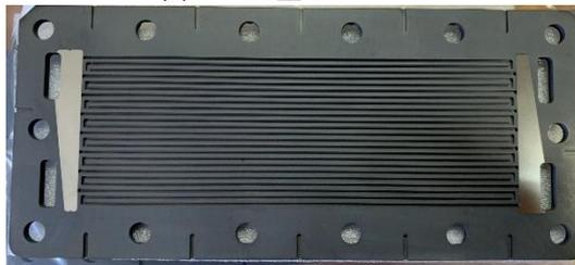
図 6 Se型セパレータ
