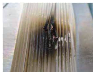
直径0.3mmステンレス、衝突速度4.01km/s
