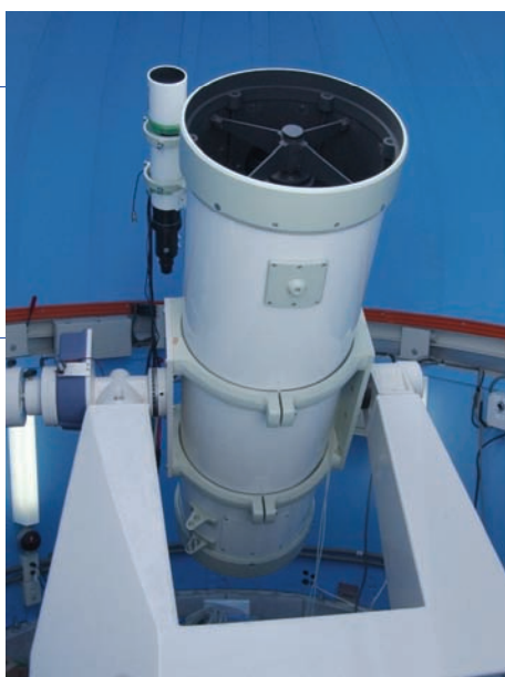
望遠鏡 タカハシ \epsilon -350 口径355mm f=1248\text{mm} F/3.6 赤道儀 昭和機械製 フォーク式 25EF
