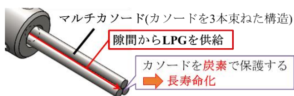
図1 電極保護用のLPGの供給方法
