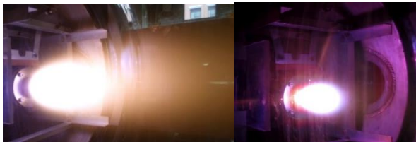
図15 アンモニア (左) と水素 (右) 推進剤の 大電力アークジェット噴射写真
