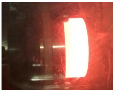
図16 赤熱アノード (表面温度 約 800 度)
