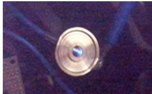
図 2.6 真空中におけるイグニッション放電 (イグニッションエネルギー 0.025 J 以下)
