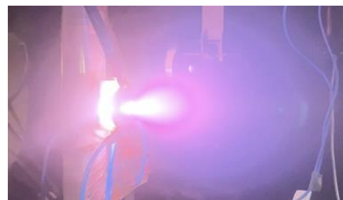
図 2.7 主放電によるプラズマ噴射 (主放電エネルギー 1J)
