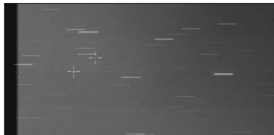
図3 TDIモードで取得した静止デブリ画像の例。十字で示している、点状に写っているのが静止デブリ、線状に写っているのは背景の恒星。電荷転送方向は右から左。左端付近は相対的に露出時間が短くなるので暗くなっている。
