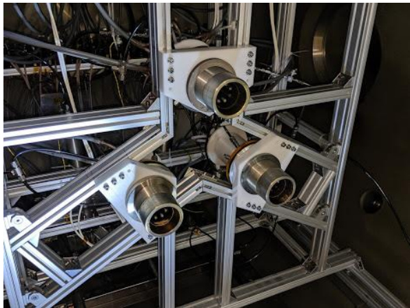
Fig. 3 従来と同様の間隔 ( d=305\text{mm} ) に調整した MPD 風洞の外観
