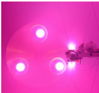
Fig. 1 チャンバフランジに取り付けられたMPD 風洞の作動中の様子(右手前は磁気プラズマセイル) [9]
