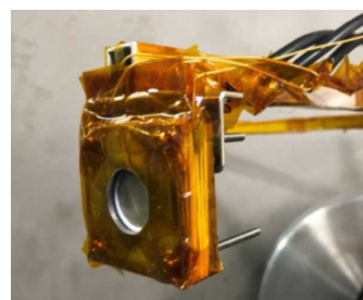
図4 製作した逆電位アナライザ
