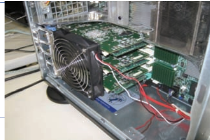
iDAQs社製FPGAボードシステム
