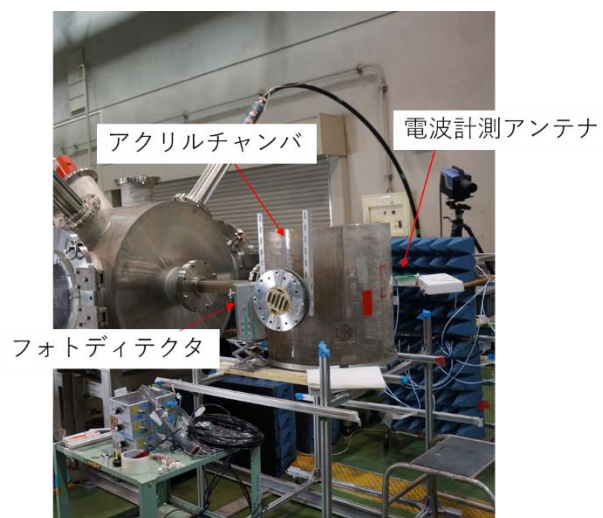
図2 衝突実験用アクリルチャンバ
