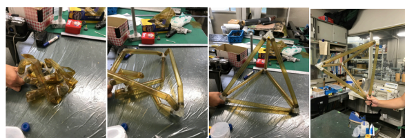
図 3 インフレーター・チューブによる構造物 (正四面体のインフレーター構造物の作成例)
