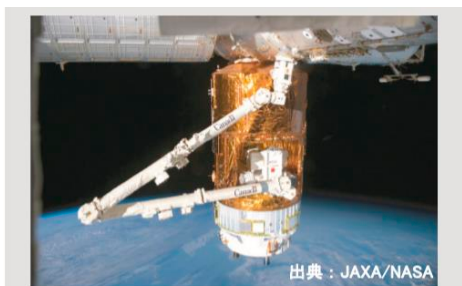
写真1 ポリイミドフィルム使用例 (写真中央琥珀色光沢部) ISSに取り付けられた「こうのとりの」3号機
