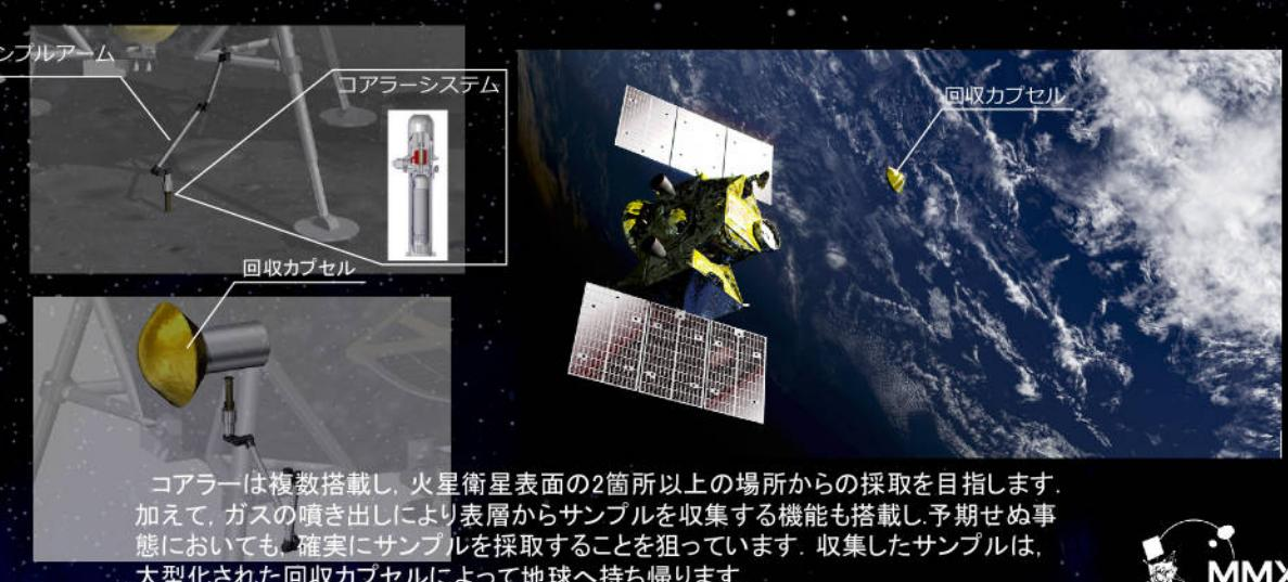
コアラーは複数搭載し、火星衛星表面の2箇所以上の場所からの採取を目指します。加えて、ガスの噴き出しにより表層からサンプルを収集する機能も搭載し、予期せぬ事態においても、確実にサンプルを採取すること狙っています。収集したサンプルは、大型化された回収カプセルによって地球へ持ち帰ります。
