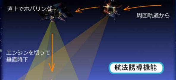
火星衛星の着陸地点周辺の地表の詳細は、事前の軌道上からの観測によって決定します。また、地表の特徴的な地形を基に高精度の航法誘導装置により、地表面をカメラで読み取りながら着陸点へ誘導し、最終的には20m四方の領域への着陸を目指します。
