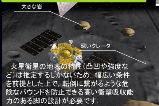
火星衛星の地表の特性(凸凹や強度など)は推定するしかないので、幅広い条件を前提とした上で、転倒に繋がるような危険なバウンドを防止できる高い衝撃吸収能力のある脚の設計が必要です。
