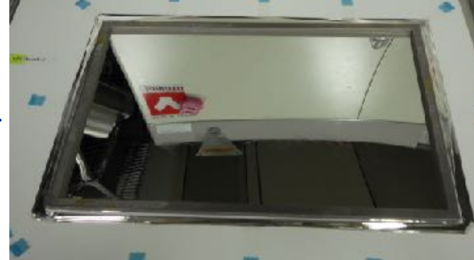
Step5: アルミ枠への接着剤塗布
