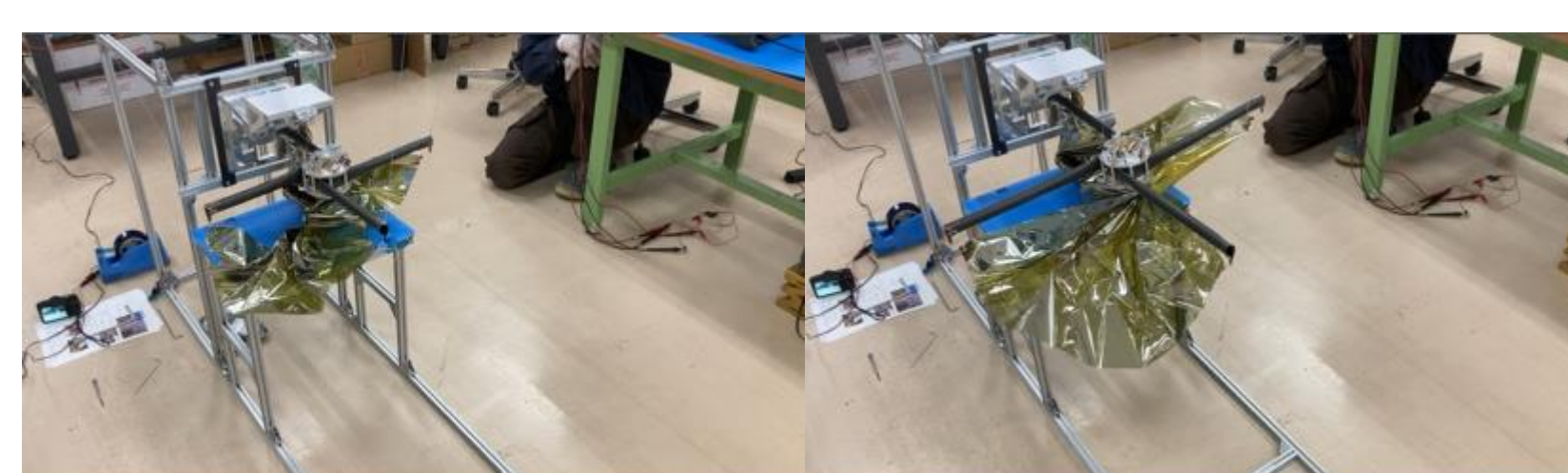
※重力補償として、中心ハブやブーム先端を糸で吊っている。※重力補償の都合、膜構造部を反転(展開後カバーが上、太陽電池等が床側にある)
