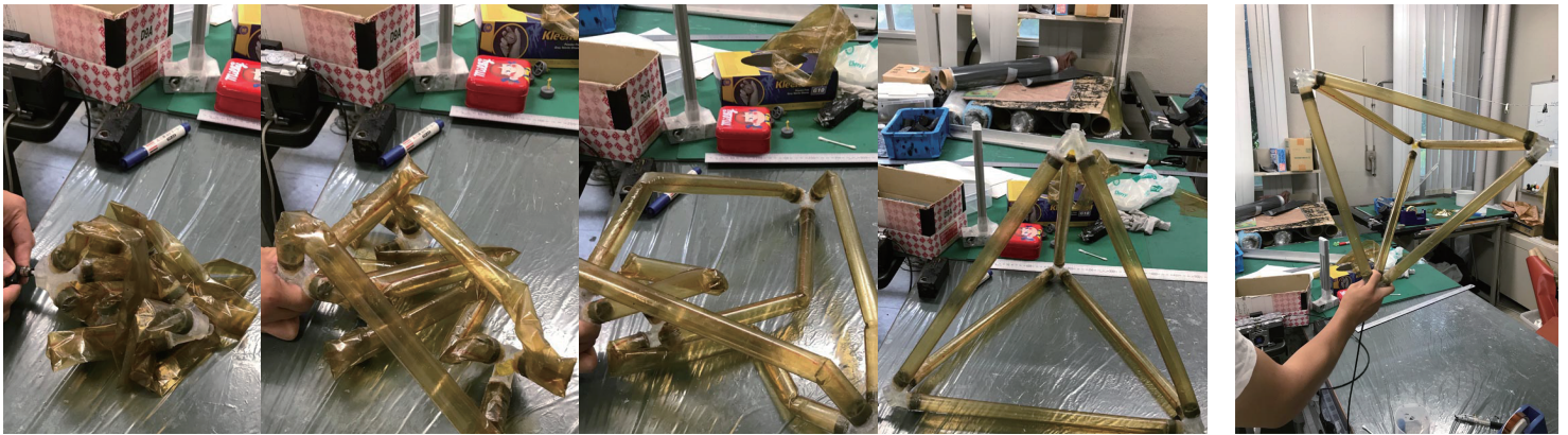
ポリイミドシートで60cm長のチューブに2気圧入ると立体構造のプリミティブがインフレーターブル構造物として容易に実現できる
