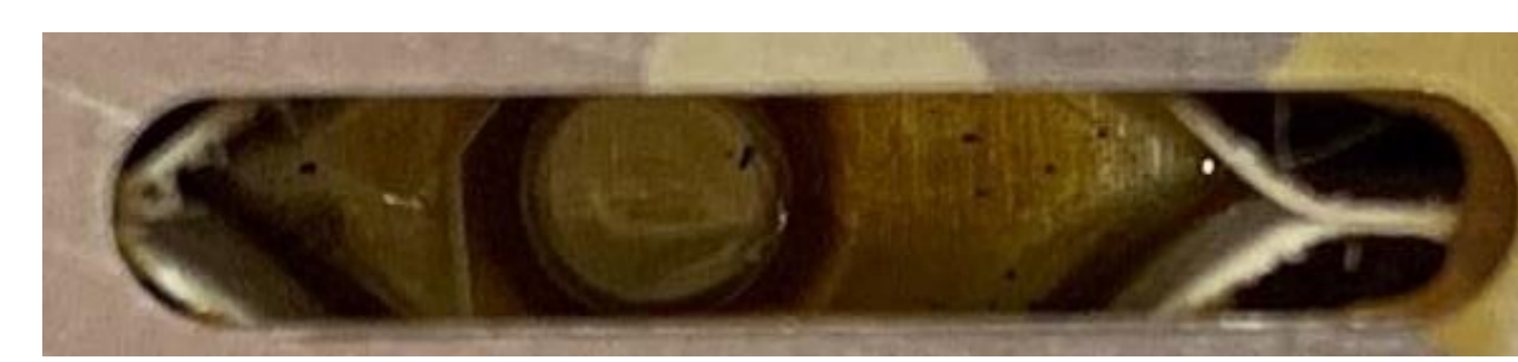
↑接着剤シートの空気溜り
