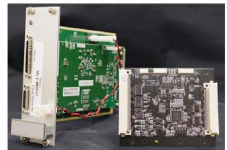
図5 InGaAsイメージセンサー用エレクトロニクス<sup>3</sup>
