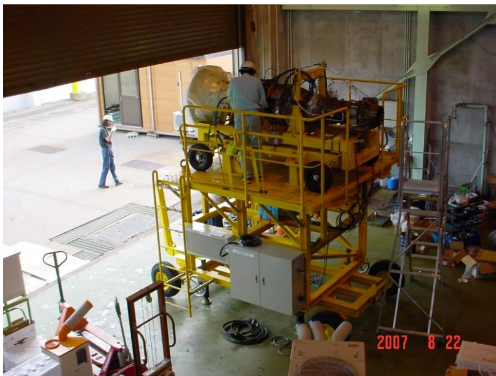
図 4-47 YJ69 屋外エンジン運転試験(能代第4回) (2007/8/22)
