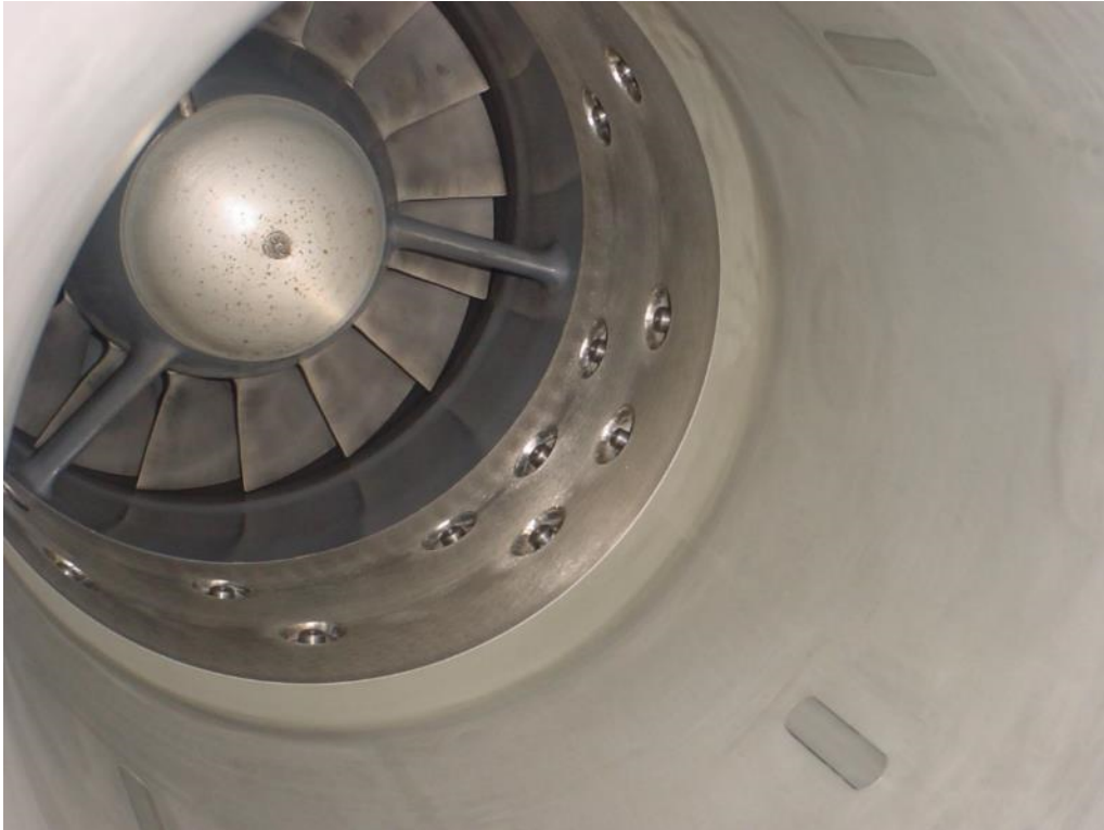
図 4-23 YJ69 水噴射装置水噴射ノズル(2001/9/18)
