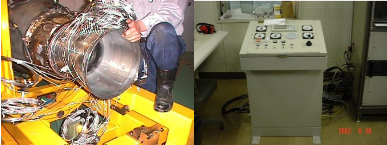
図 3-7 固定 CD ノズル、現地運転用エンジン運転盤
