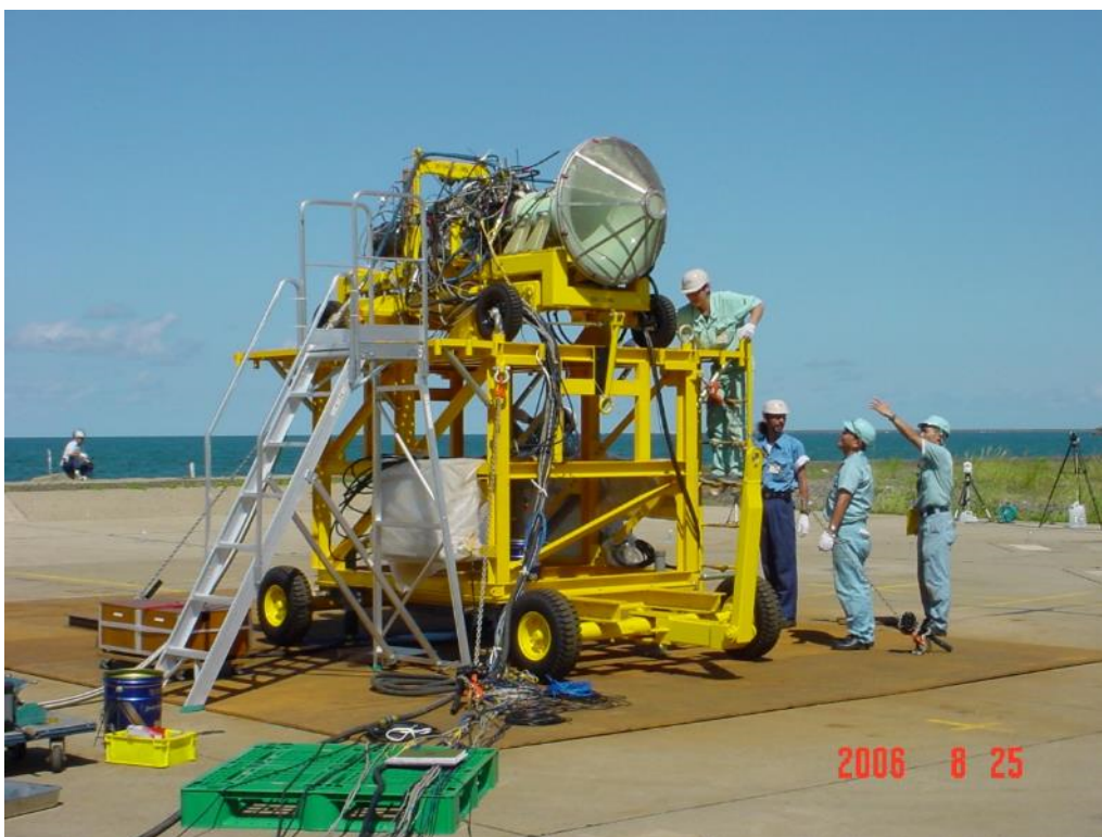
図 4-46 YJ69 屋外エンジン運転試験(能代第 3 回) (2006/8/25)
