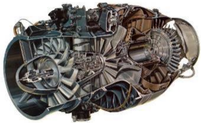
図 2-1 YJ69-T406 エンジン (テレダイン社パンフレットより)
