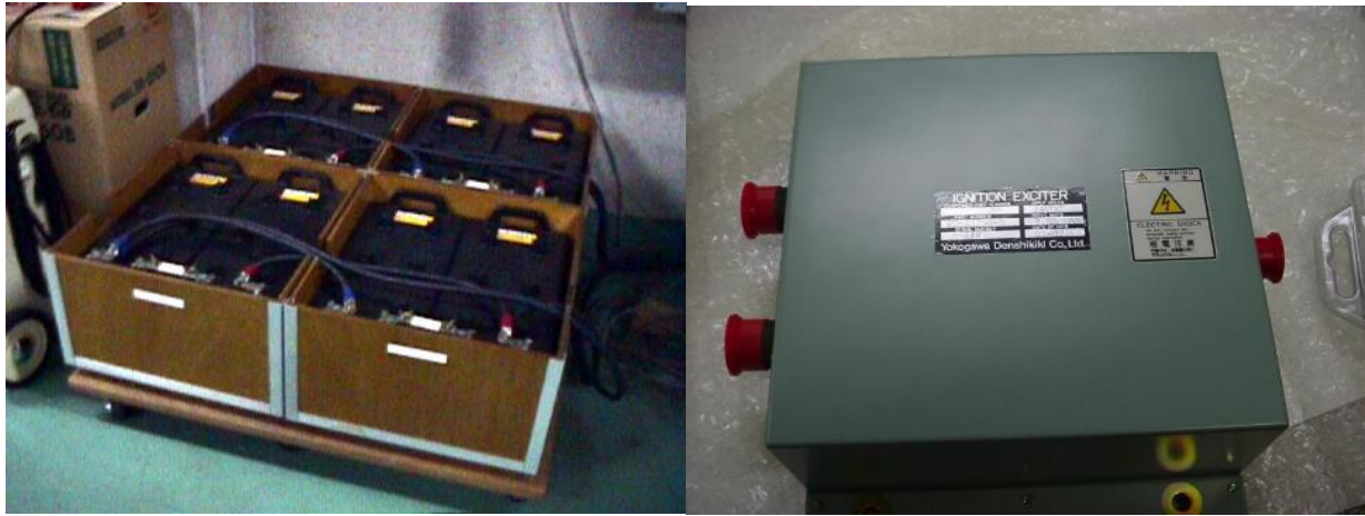
図 3-9 現地運転用バッテリーシステム、強化エキサイター
