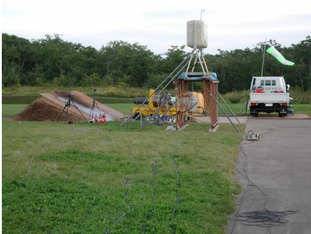
図 4-35 YJ69 屋外騒音予備試験(大樹町) (2003/9/14)燃料タンク嵩上げ
