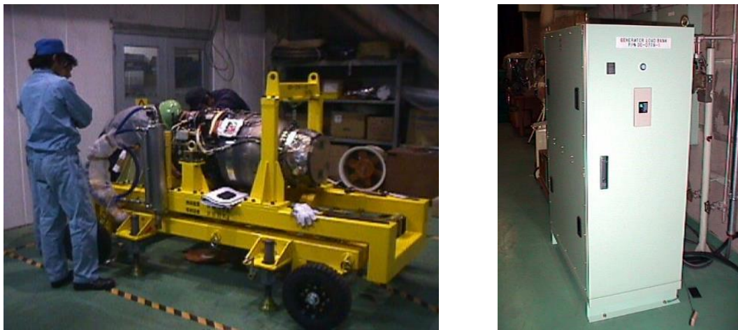
図 3-8 オーバーホール用エンジン調整架台、ジェネレータロードバンク
