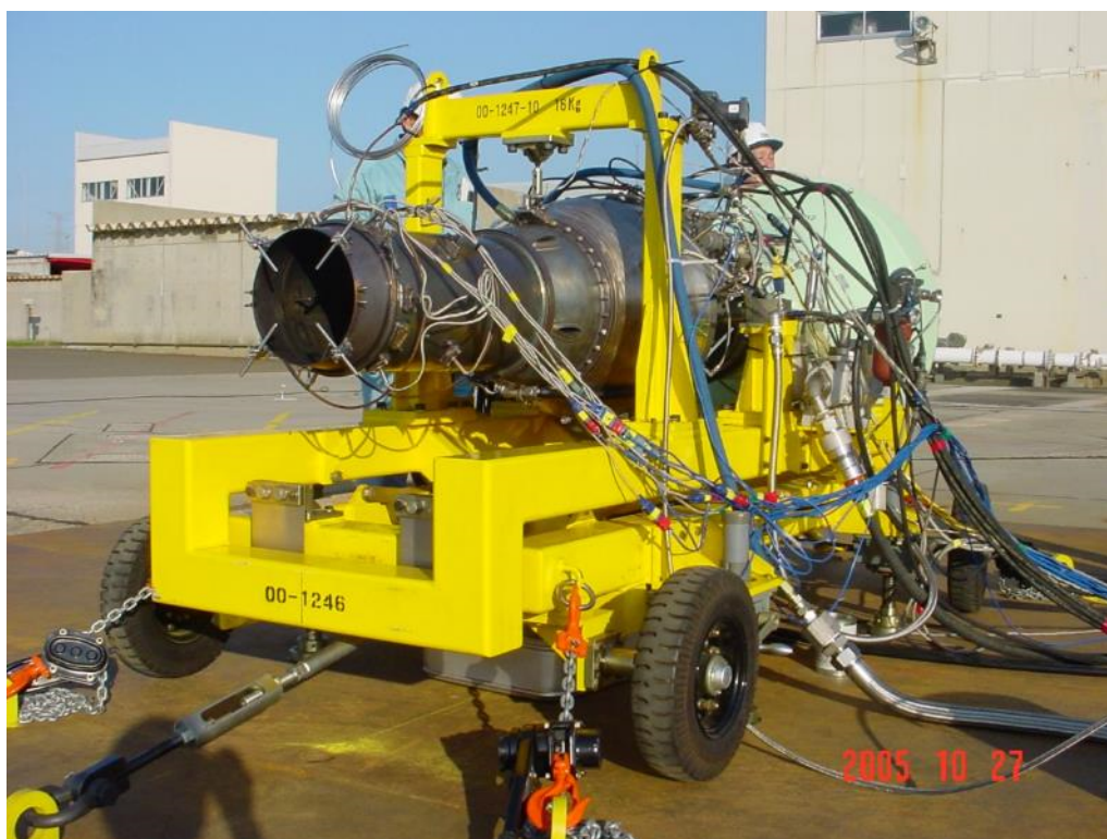
図 4-42 YJ69 屋外エンジン運転試験(能代第2回) (2005/10/27)
