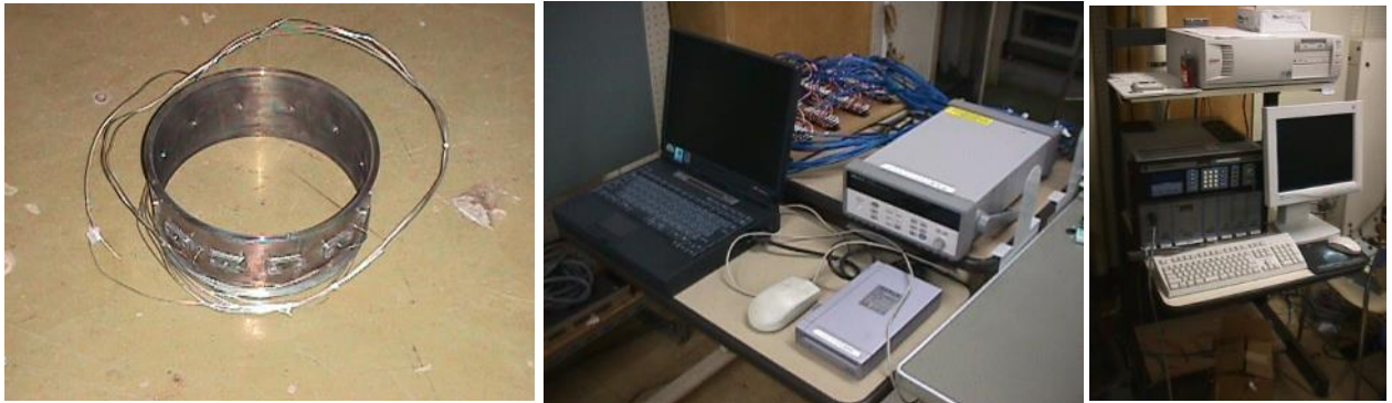
計測リング、多点熱電対ロガー、多点圧力計測システム
