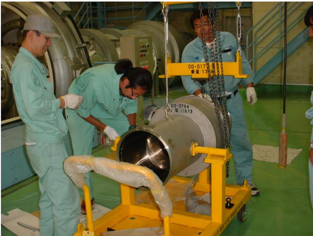
図 4-24 ATF に搭載される模擬エンジン(2001/9/29)
