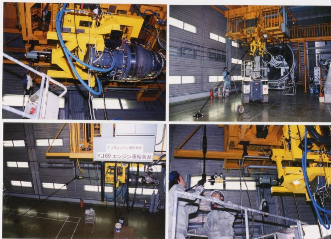
図 3-6 インライン推力校正(2000/3/3)
