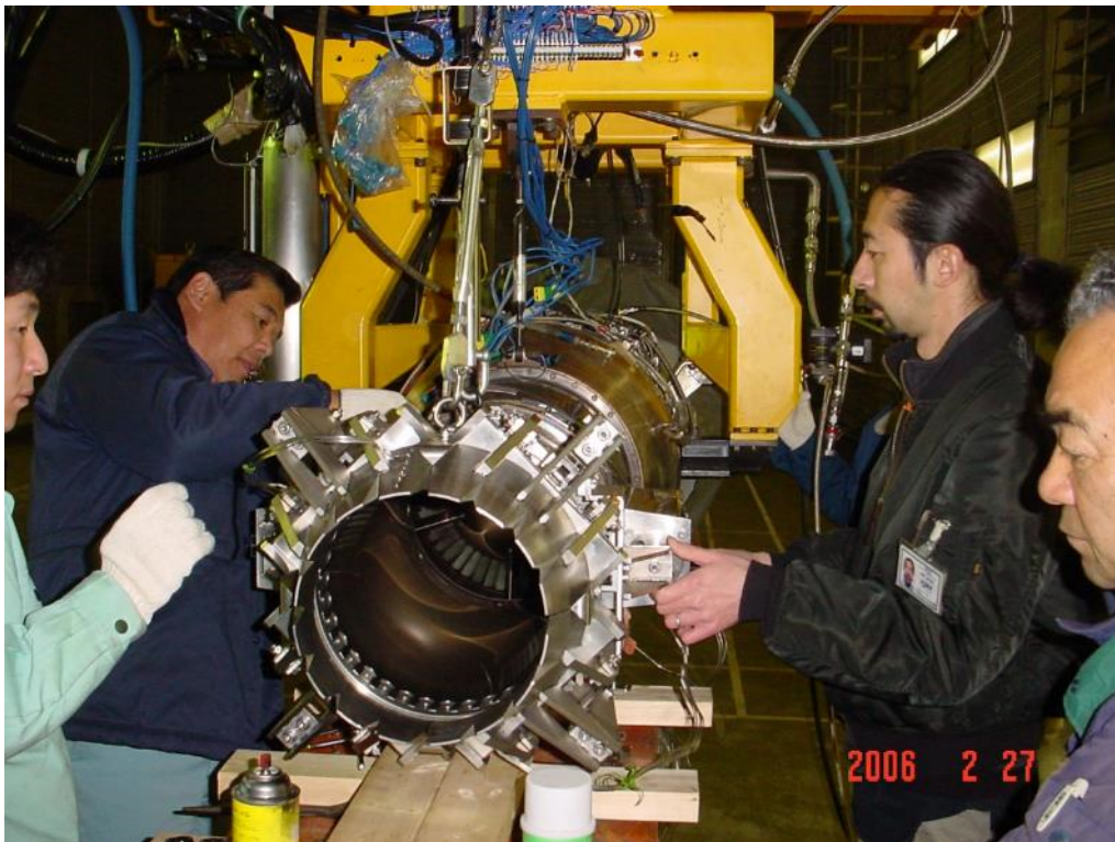
図 4-45 YJ69 可変ノズルエンジン試験 (2006/2/27)
