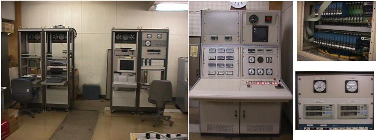
画像記録ラック、改修済運転盤、右上：計装アンプ、右下：高精度推力計測器
