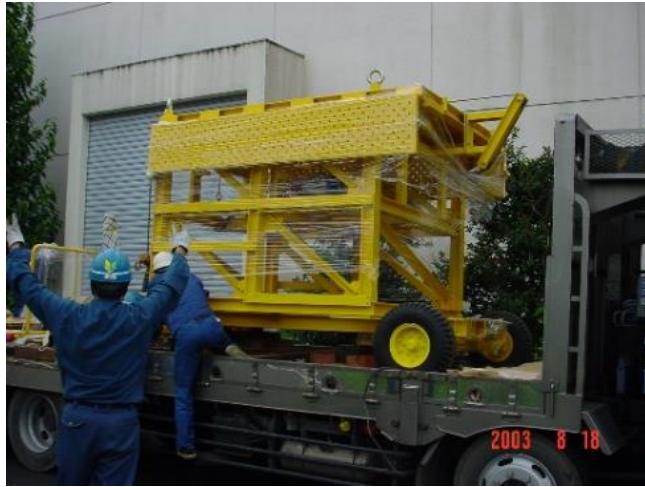
図 3-12 高所運転用補助架台
