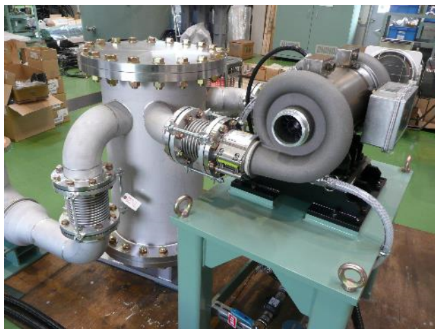
図 3-16 空気冷却用試作膨張タービン
