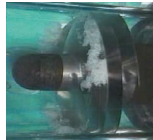
キャビテーション発生状況(水試験)
