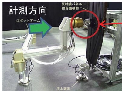
月面組立ロボット用画像計測装置
