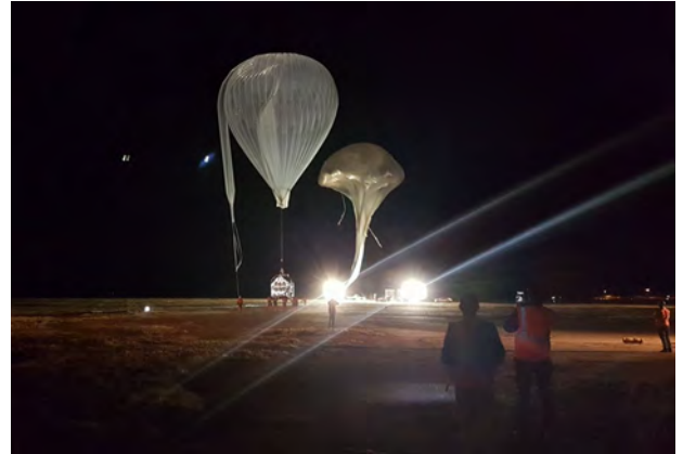
図 2: CNES による補助気球を用いた放球 [7]。
