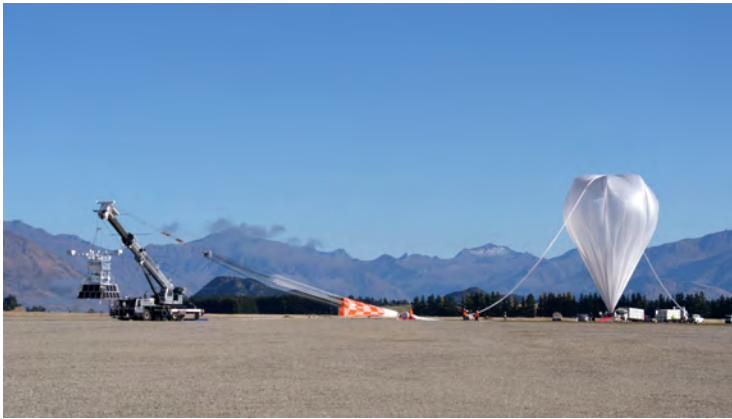
図 1: NASA によるダイナミック放球法での放球 [6]。
