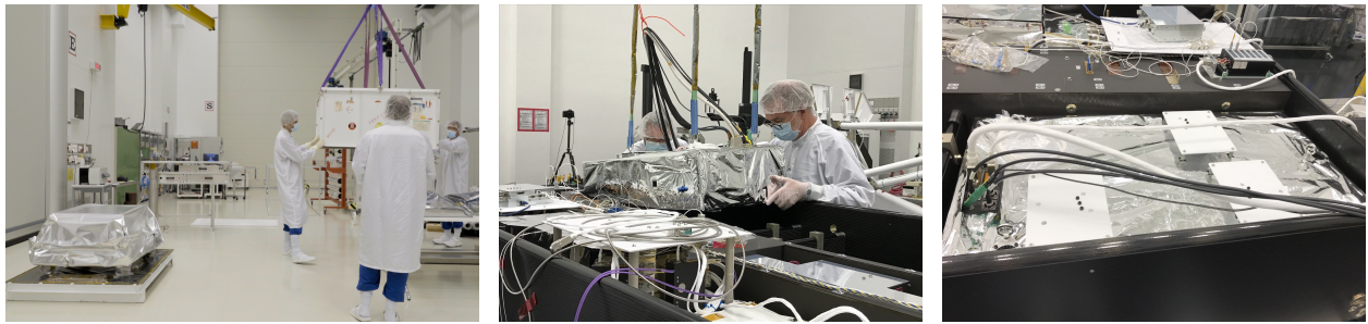
図 8: ドイツのマックス・プランク太陽系研究所で輸送コンテナを開ける様子(左)、光学ユニットを焦点面装置箱への組み込み作業(中)、組み込まれた SCIP 光学ユニット(右)。
