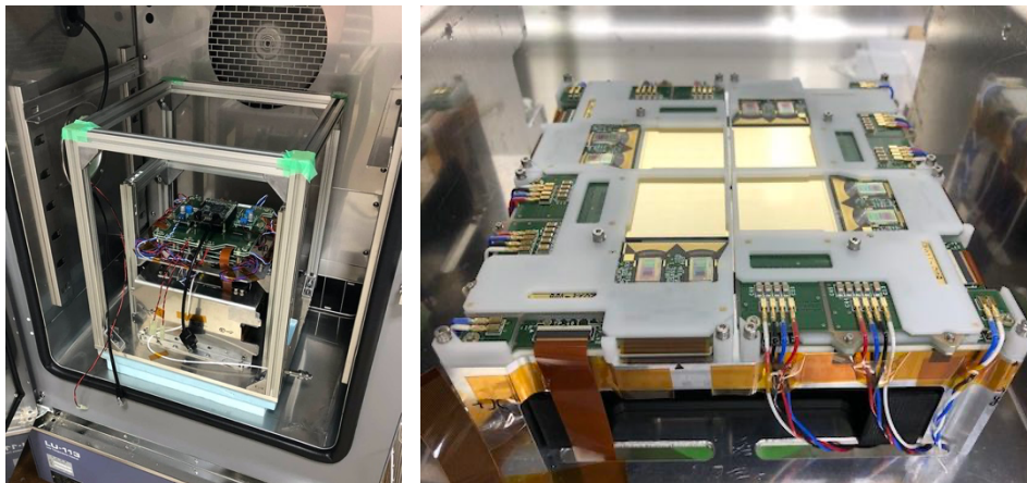
開発中の miniSGD。全体構造(左、耐圧容器はまだ)と、CdTe 半導体面(右)。
