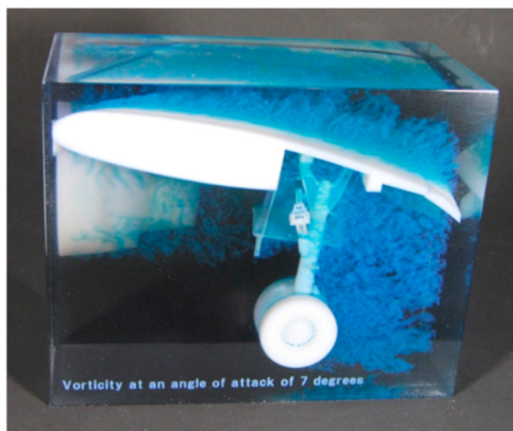
図11 透明樹脂を使った3D プリンタモデル （航空機ランディングギア周り）
