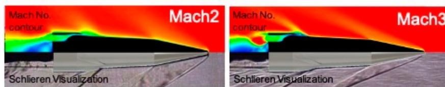
図 2: CFD 解析結果と風洞実験における流れ場の可視化結果の比較
