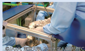
©JAXA, 東京大学, 九州大学, JAMSTEC キュレーションクリーンルーム内でのコンテナ開封作業
