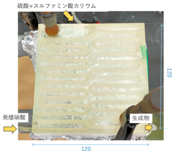
第3図 試作した小型連続反応器における合成の様子
