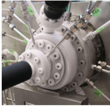
図 10 LN2 予冷による LOX 電動ポンプ
