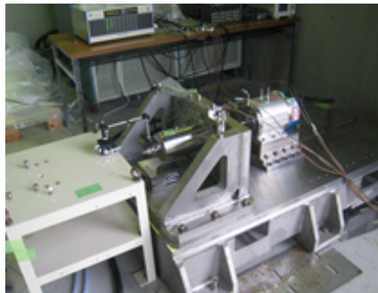
図8 モーターロータ回転試験（角田宇宙センター）
