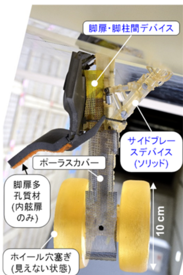
図 4. RJ 脚での低騒音化デバイス初期案と 10%単体脚模型 (2019 年度風洞試験): 青字は RJ 脚で新たに加えたデバイス
