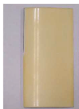
TSPを塗装した 翼型模型
