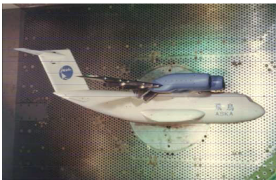
STOL実験機「飛鳥」 7%縮尺模型 (1987年)
