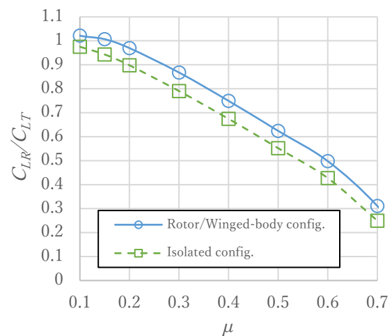
図5 前進率と揚力分担率の関係 (Rotor/Winged-body config. : 空力干渉時の揚力分担率, Isolated config. : 翼胴単体とロータ単体の揚力分担率)
