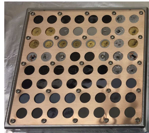
QCC型宇宙曝露試料（窓材なし）
