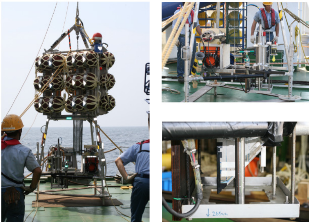
図 5: 二次元酸素センサと制御装置を搭載した、ランダーシステム。写真左: ランダーシステム全体。写真右上: センサ部分と制御部分。写真右下: センサを貼り付けた潜望鏡部分。この潜望鏡を海底に突き刺して、断面の酸素濃度イメージングを行う。
