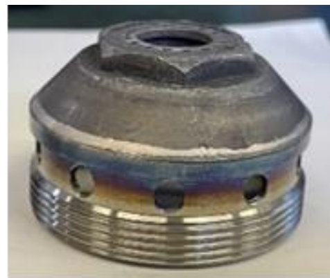
図9 エンジンインジェクター (左：プリチャンバなし, 右：プリチャンバあり)
