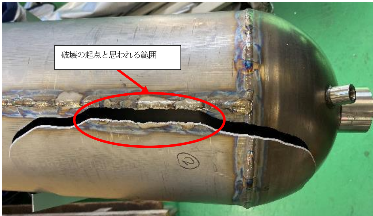
図7 タンクH 破壊後拡大図
