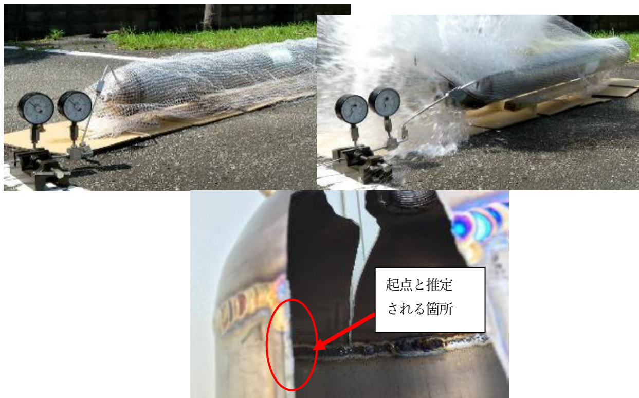
図5 耐圧試験(タンクE) (左上:破壊前, 右上:破壊直後, 下:破壊後)
