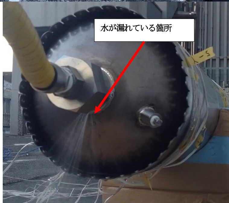
図 10 212 サイクル目水漏れ(上:全体図, 下:拡大図)
