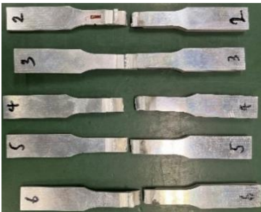
図10 溶接継手試験片 試験後
