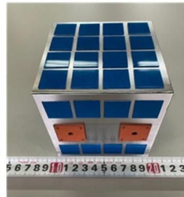
図 2 超小型衛星 OSU-1 のモックアップ
