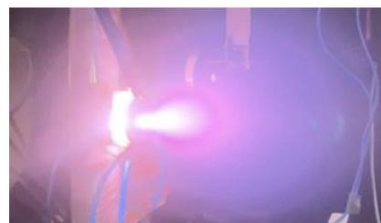
図 6 1J/1W-PPT ヘッドとプラズマ噴射
