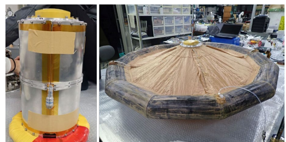
図 3 : RATS のフライトモデル (左 : エアロシェル収納状態, 右 : エアロシェル展開状態)
