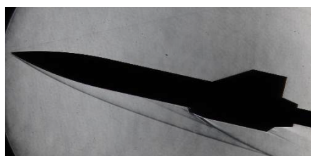
図 3. 機体空力特性試験 (Mach 5)
