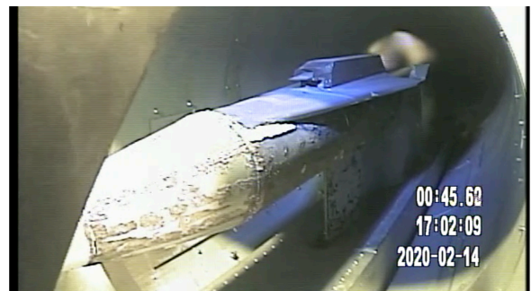
図 9. 推進風洞実験 (Mach 4 条件)
