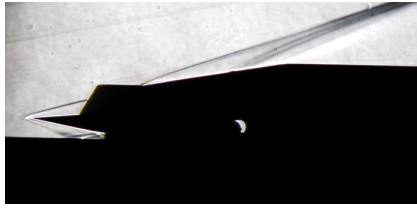
図 5. インテーク性能試験 (Mach 5)
