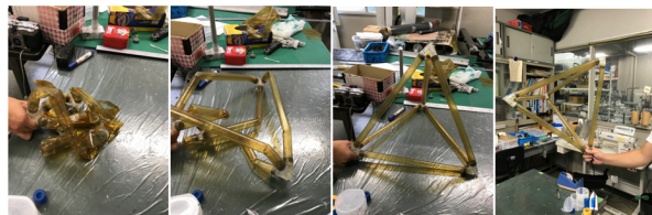
図3 インフレータブル・チューブによる構造物 (正四面体のインフレータブル構造物の作成例)
