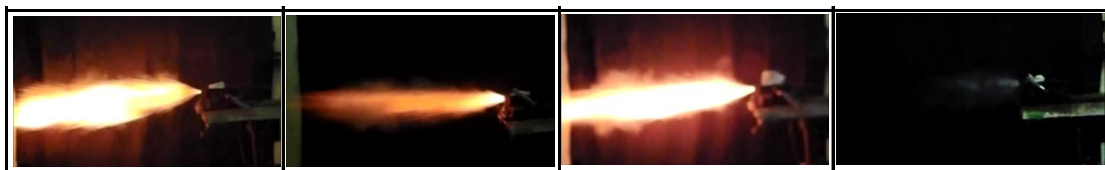
図6 火炎抑制機構の効果。
