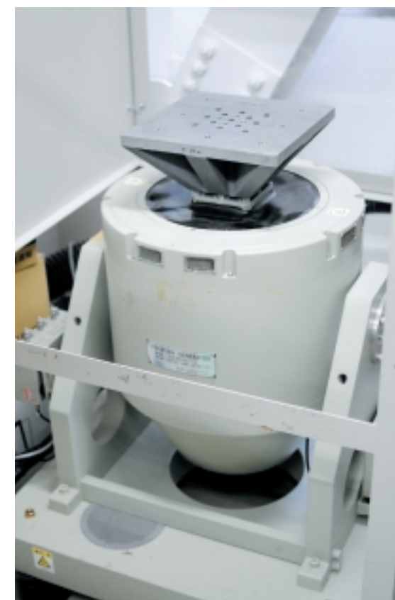
振動試験機。ロケットが打ち上がる時の振動環境を模擬するための装置。この構造的な部分が上下に動き、この上に人工衛星を乗せてテストする。
