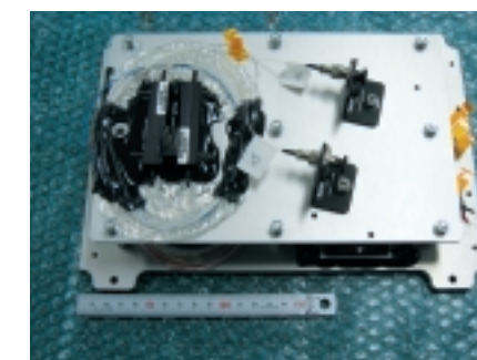
H21年度製作中の搭載型FBGによるAE計測システム 画像提供: (株)IHI検査計測
