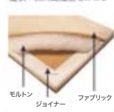
壁装のクッションであるモルトンに高吸音性の超極細のガラス繊維を利用
