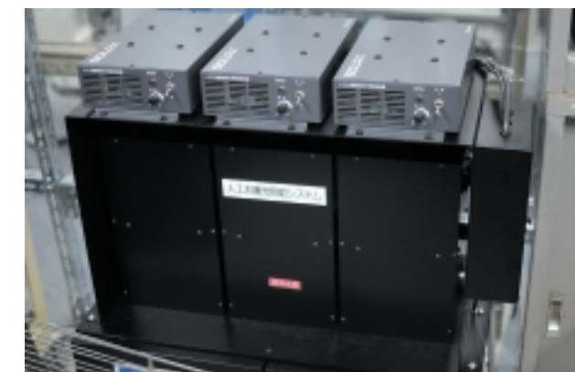
宇宙空間において、実際にどれくらい太陽の光が照射されるかを試験するためのシステム。実際に衛星を入れて、上からライトを照して実験する。
