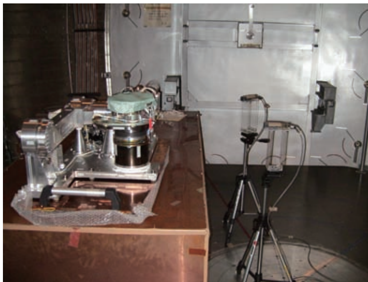
図 4.3.8-5 単体磁気試験(JAXA 相模原キャンパス／磁気シールドルーム)の様子 供試体の正面に 2 機の磁気センサーを配置している。
