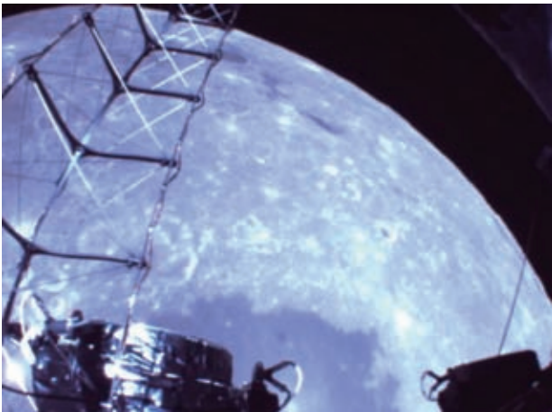
(写真2)月軌道投入後の LRS アンテナの展開と LMAG アンテナの展開
