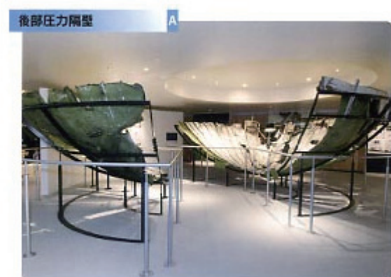
第1図 後部圧力隔壁 (2分割)
