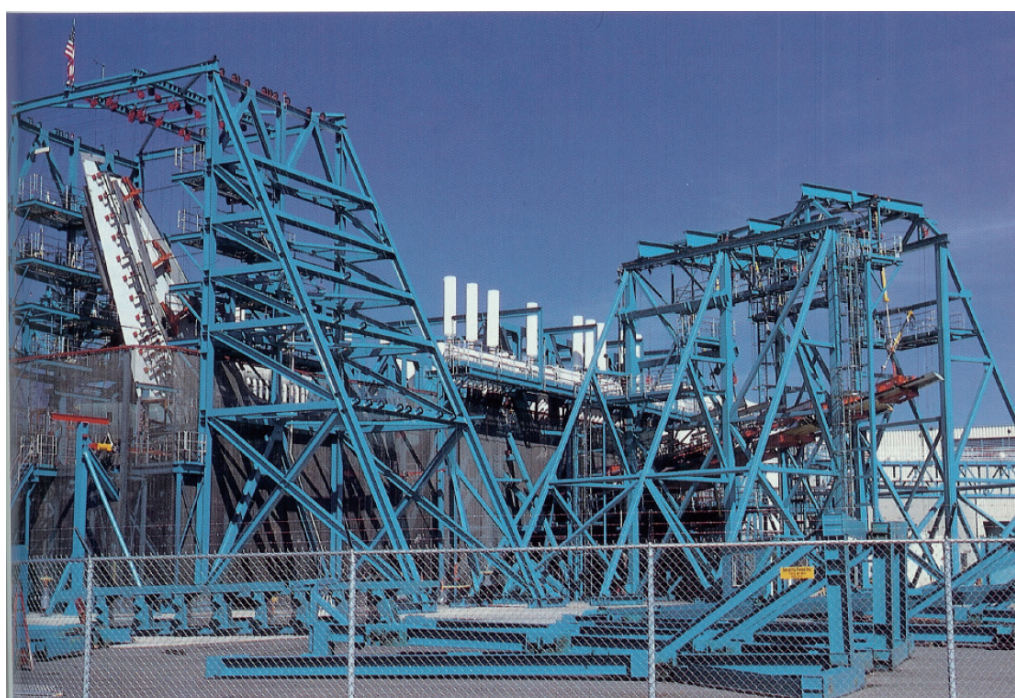
図 3.2.5 全機疲労試験状況(許可を得て文献[2]より転載)
