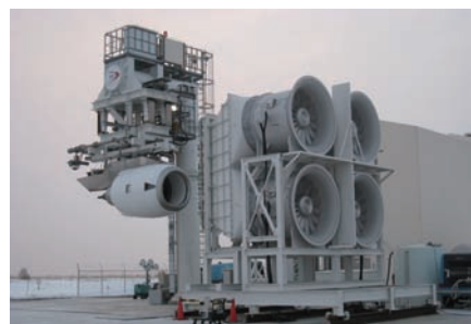
図 4.2.12 屋外エンジン試験設備 (防衛省提供)
