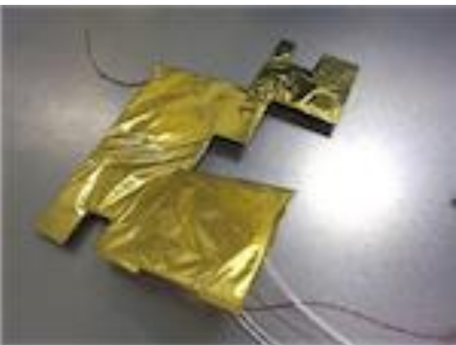
EQUULEUSの多層断熱材と一体化したCLOTHセンサ部
