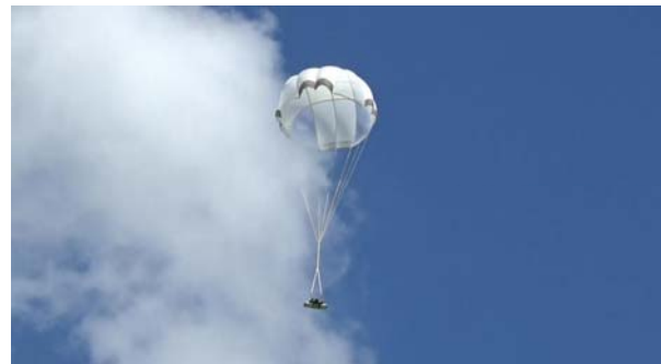
図 7 : セスナからの投下試験の様子
