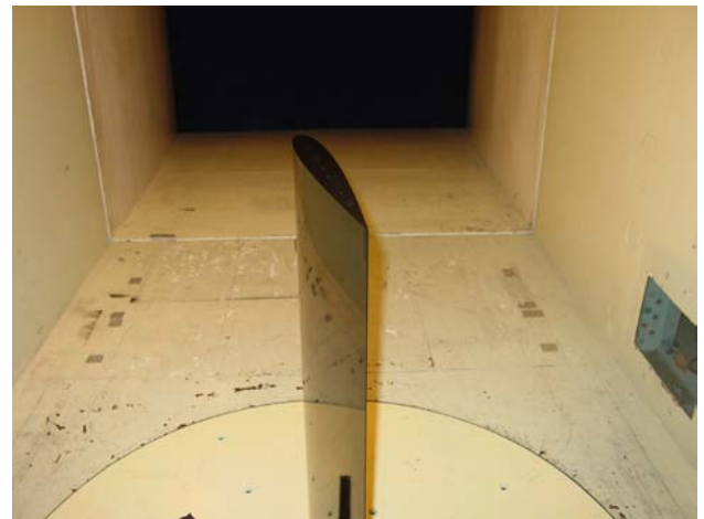
図 1 JAXA-LWT2 風洞に設置された NACA0012 翼翼端模型
