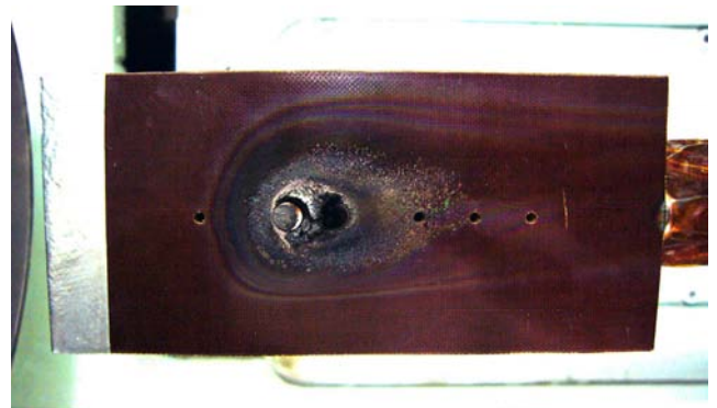
図 10 実験後の模型における焼けた跡
