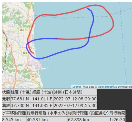
図 5 経路予測結果の例。赤線が示すのが上昇中の経路、青線が示すのが下降中の経路 JavaScript によってウェブブラウザを介して表示できるほか、高さ方向を含めた 3 次元の KML ファイルによる飛行経路表示や経路のデータを CSV ファイルに書き出すことができる。経路予測に使う気象データはウェブを通じて随時取得するほか、あらかじめ指定した領域のデータを必要に応
