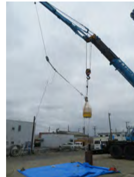
図 3: 第二保持点から気球尾部での吊り下げに移行。
